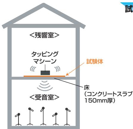
JIS A 1440-1「実験室におけるコンクリート床上の床仕上げ構造の床衝撃音レベル低減量の測定方法—第1部:標準軽量衝撃源による方法」準拠床衝撃源として、軽量床衝撃音発生器(タッピングマシン)を使用。残響室コンクリートスラブ床板の厚さは150mmとし、その上に試料を施工し、試験体とします。一般的に2,000~3,000Hzの範囲が聴覚の感度が高いとされています。
