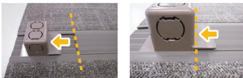
②カバーをドレーンレールプラス G 本体に取り付けてください。片方を先にはめ込み、製品を丸めるように軽く曲げ、もう片方をはめ込んでください。手のひらで上から押さえ、浮きがないことを確認してください。
